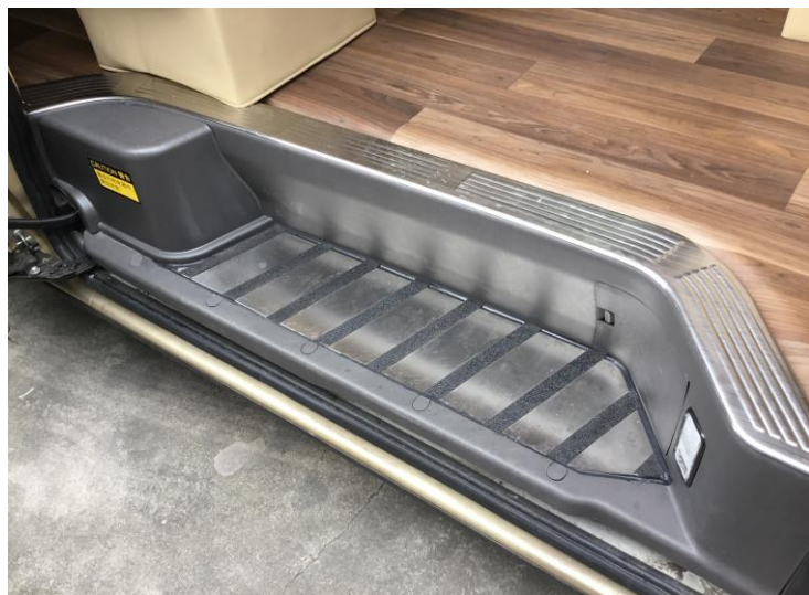
中门整体 不锈钢踏步 带防滑条
